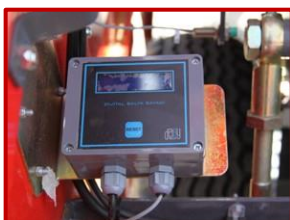
เครื่องนับมัดฟางแบบดิจิตอล DIGITAL BALE COUNTER
