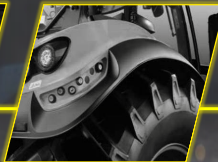
> การควบคุมภายนอกทั้งสองด้านสำหรับการยกด้านหลังและ PTO และขึ้นอยู่กับรุ่น วาล์วสปูลหนึ่งตัว
