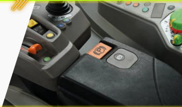
▲ ระบบเบรกจอร์นอลอิเล็กทรอนิกส์ (EPB) ในรุ่น RVshift และ TTV
