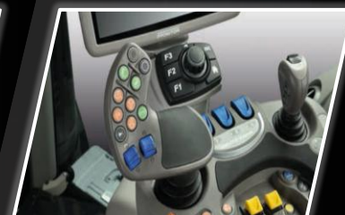
▲ การควบคุมวาล์วสพูลไฟฟ้า ผู้ปฏิบัติงานสามารถเลือกได้ระหว่างการควบคุมที่ปลายนิ้วสปีดวาล์ว หรือปุ่มหมุนที่สะดวกสบายบนจอยสติ๊ก MaxCom
