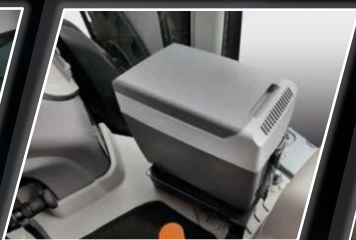
▲ ถังระบายความร้อนแบบถอดออกได้ ช่วยให้อุณหภูมิห้องโดยสารเย็น
