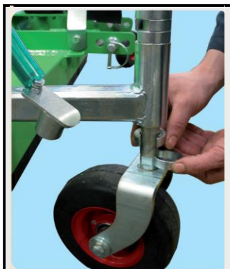
การปรับความสูงของการตัดที่ง่ายและรวดเร็วบนล้อหน้า
