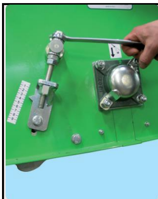
ปรับความสูงในการตัดลูกกลิ้งด้านหลังได้ง่ายด้วยการทำงานของประแจด้านนอก
