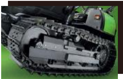
นวัตกรรมช่วงล่างพร้อมลูกกลิ้ง 6 รางเพื่อความเสถียรและการยึดเกาะสูงสุด
