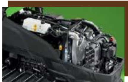
กะทัดรัดและมีประสิทธิภาพ เครื่องยนต์ FARMotion ที่มีการเคลื่อนที่แบบรวมที่ปรับให้เหมาะสมเพื่อกำลังและประสิทธิภาพ พัดลม Visco และตัวกรองอากาศ PowerCore
