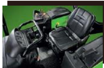
ที่นั่งผู้ขับขี่รูปแบบใหม่ : ติดตั้งบน SilentBlocks เพื่อการจัดการสั่นสะเทือนที่ส่งไปยังคนขับและด้วยหลักวิทยาศาสตร์ขั้นสูงสุด
